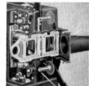
Bild 6: Projektionstabus aufgeklappt, Wechselschieber eingelegt
