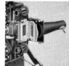
Bild 4: Dia-Vorsatz mit eingelegter Bildbandführung
